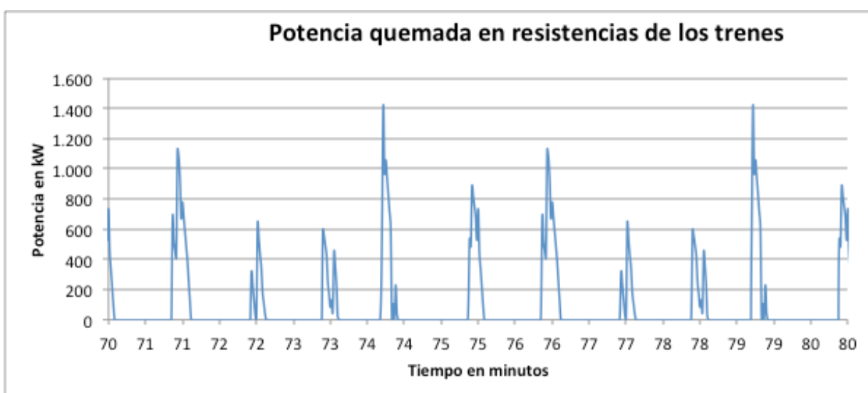
Figura nº 14. Detalle de la potencia enviada al conjunto de los bloques de resistencias de frenado de los tranvías entre el minuto 70 y el minuto 80.
